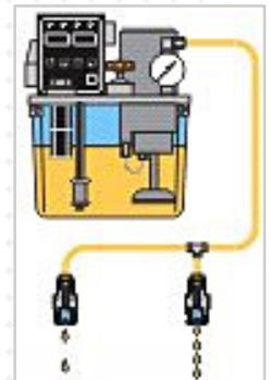
**Pompes en continu, pour lubrifications en grande quantité, il faut utiliser un système en continu. Ces systèmes sont habituellement utilisés sur des équipements possédant un grand nombre de points de lubrification**
